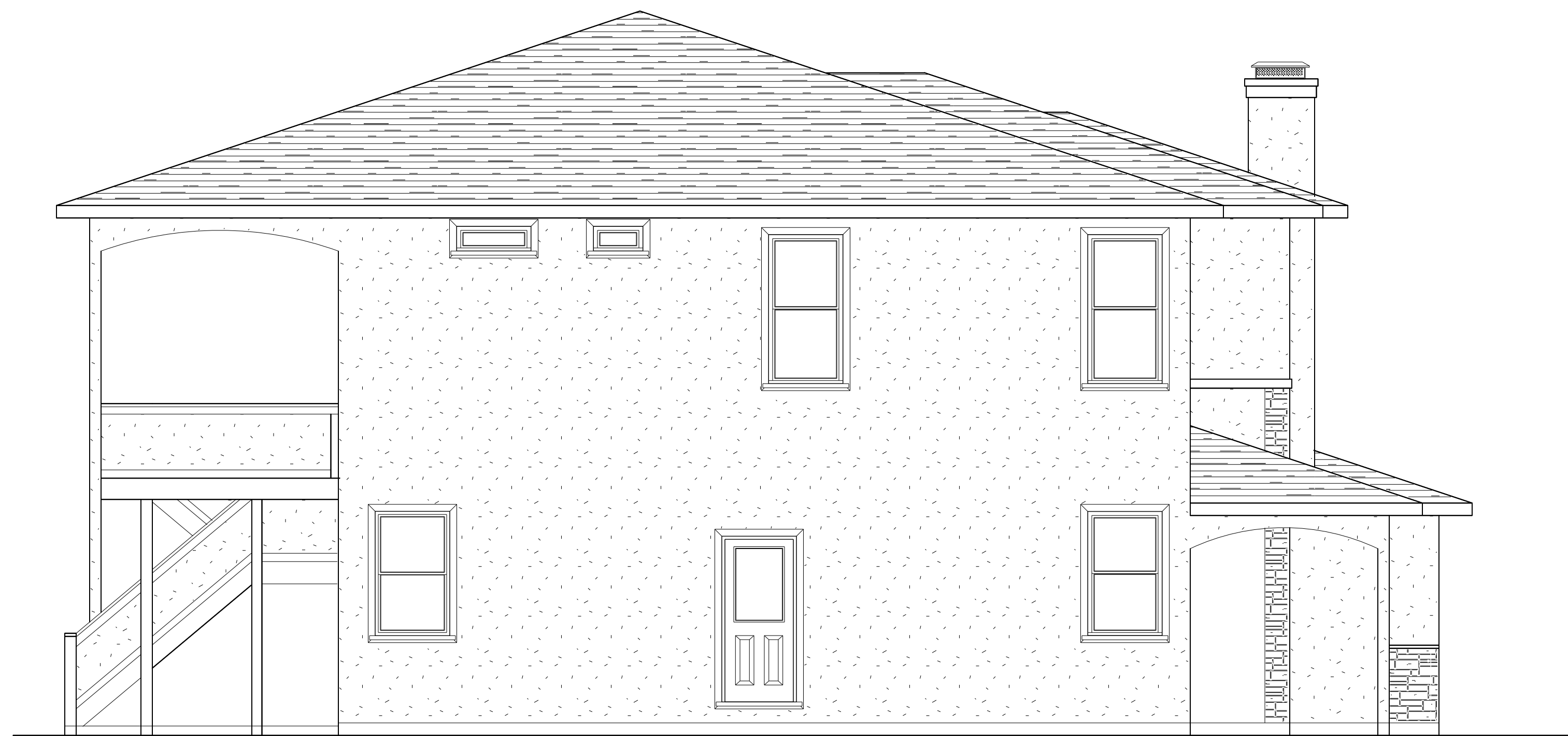
LEFT ELEVATION SCALE: 1/4"=1'-0"
