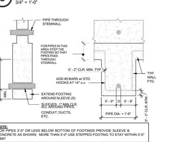
**2 PIPE THRU STEMWALL & REINFORCING**
